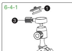
6-4-2: 撮影時: スマートフォンで撮影をする時はスマートフォンホルダー横面のネジ穴に取付プレート ① を硬貨やドライバーを利用して、確実に取り付けます。
